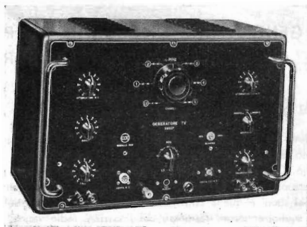
Fig. 7.1 - Aspetto esterno di generatore di segnali TV (sweep). La deviazione di frequenza è ottenuta con lamina vibrante fissata ad equipaggio di altoparlante. L'ampiezza della deviazione può giungere a 12 megacicli. Il generatore consente di ottenere i segnali per l'allineamento delle medie frequenze da 0,3 a 50 megacicli e quelli per i circuiti accordati dei cinque canali TV. (CGE mod. 304).
