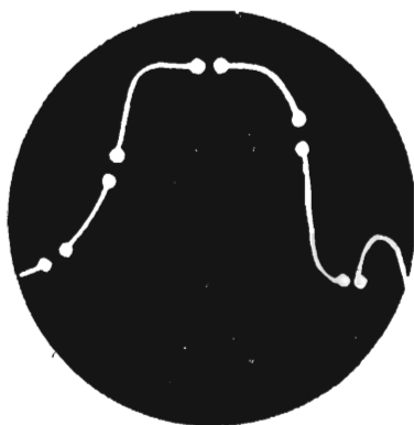
Fig. 5.13 - Marcatura della frequenza lungo una curva di responso con il sistema della modulazione di intensità.
