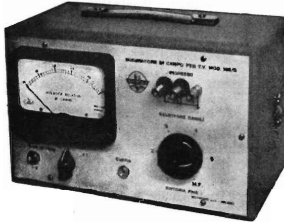
Fig. 11.1 - Tipico esempio di strumento misuratore di intensità di campo (Metronix mod. 105/S).
