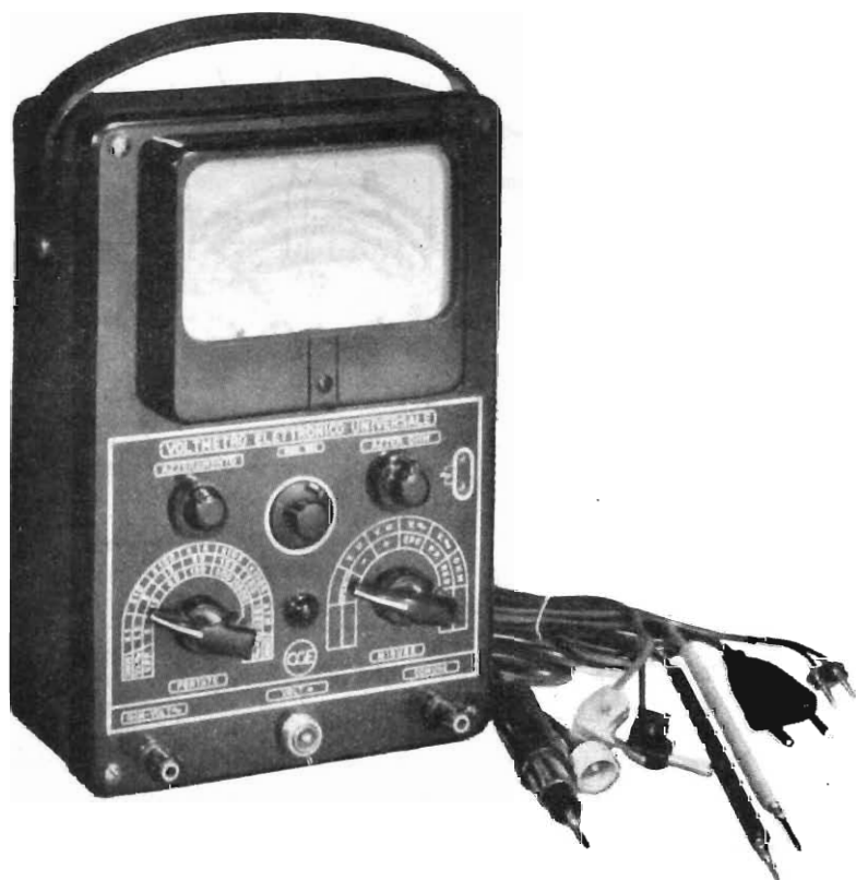
Fig. 9.1 - Esempio di voltmetro a valvola, adatto per la misura di tensioni continue, alternate ed oscillanti, nonché di resistenze.
